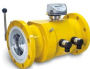
TR22渦輪錶以實際立方公尺為單位顯示流量。進氣經過入口加速，衝擊渦輪葉片，渦輪旋轉透過多階齒輪和磁力接頭，傳送至八位數計數器。無論從計量的觀點或材質的角度看，渦輪錶都適合能源供應界的燃氣和多種工業用氣體。
