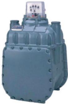
AL系列皮膜錶是正位移計量裝置，其皮膜兩端形成固定體積的計量腔室。皮膜錶只要有些許壓降即開始循環，其腔室輪流自入口充滿氣體，然後自出口排空。計算錶的循環次數，即可正確的計量氣體體積。
